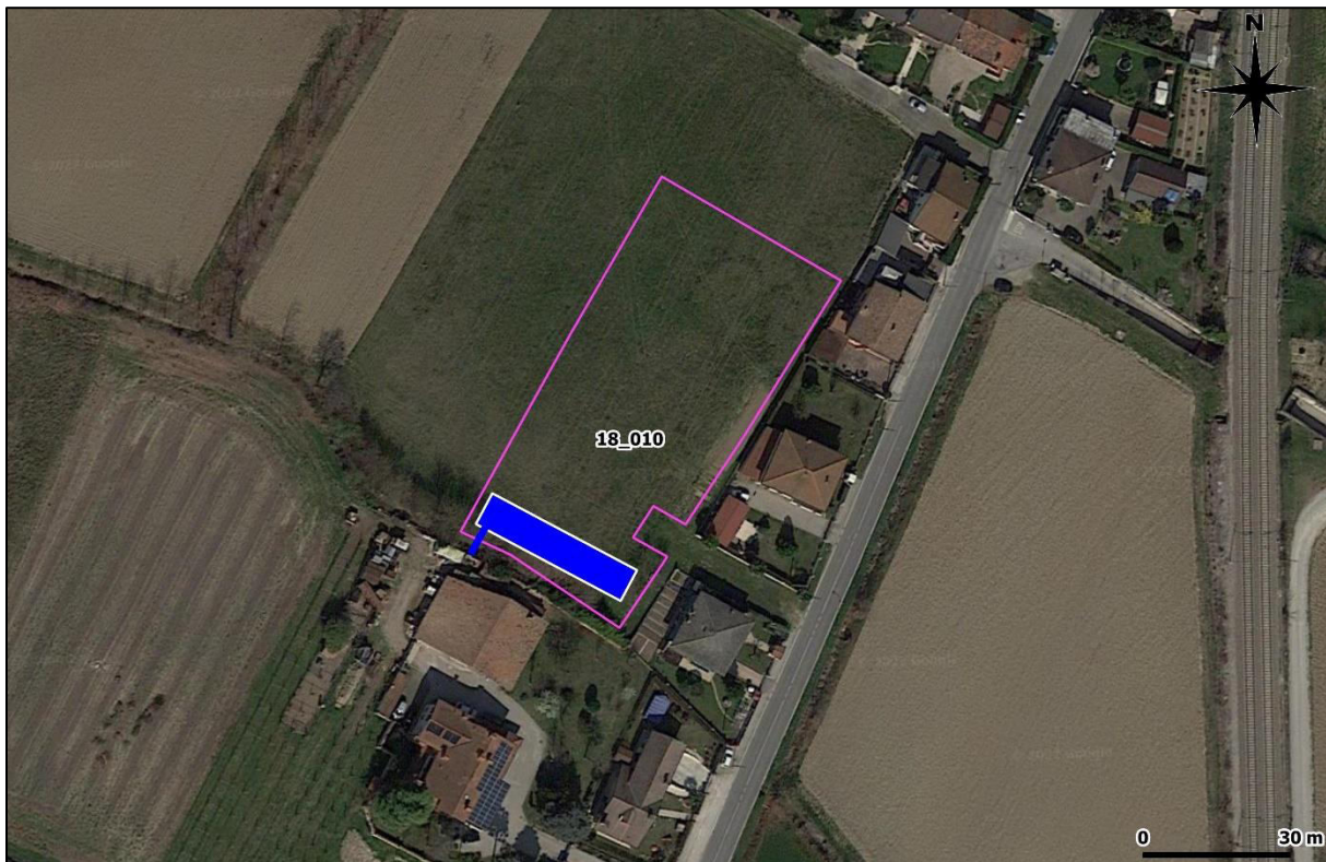
Figura 6.3.25. Opera di mitigazione proposta. Realizzazione di volumi di invaso interrati e/o superficiali per volume minimo di 234 m 3 con scarico tarato in corso idrico superficiale. La posizione dell'opera di mitigazione è indicativa e non vincolante
